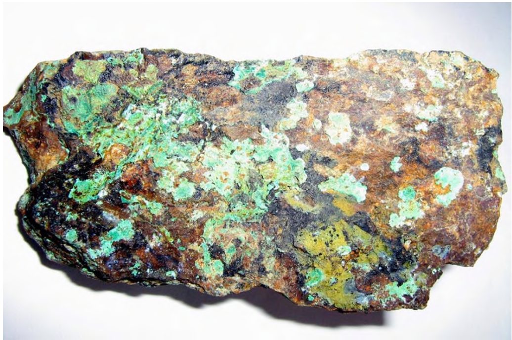
Рисунок 4.2.4 – Пятнистая структура. На поверхности в виде пленок, скорлуповатых агрегатов, толщиной 0,6-1,0 мм – хризоколла, реже – малахит, главным образом, в виде тонких прожилков [1]
