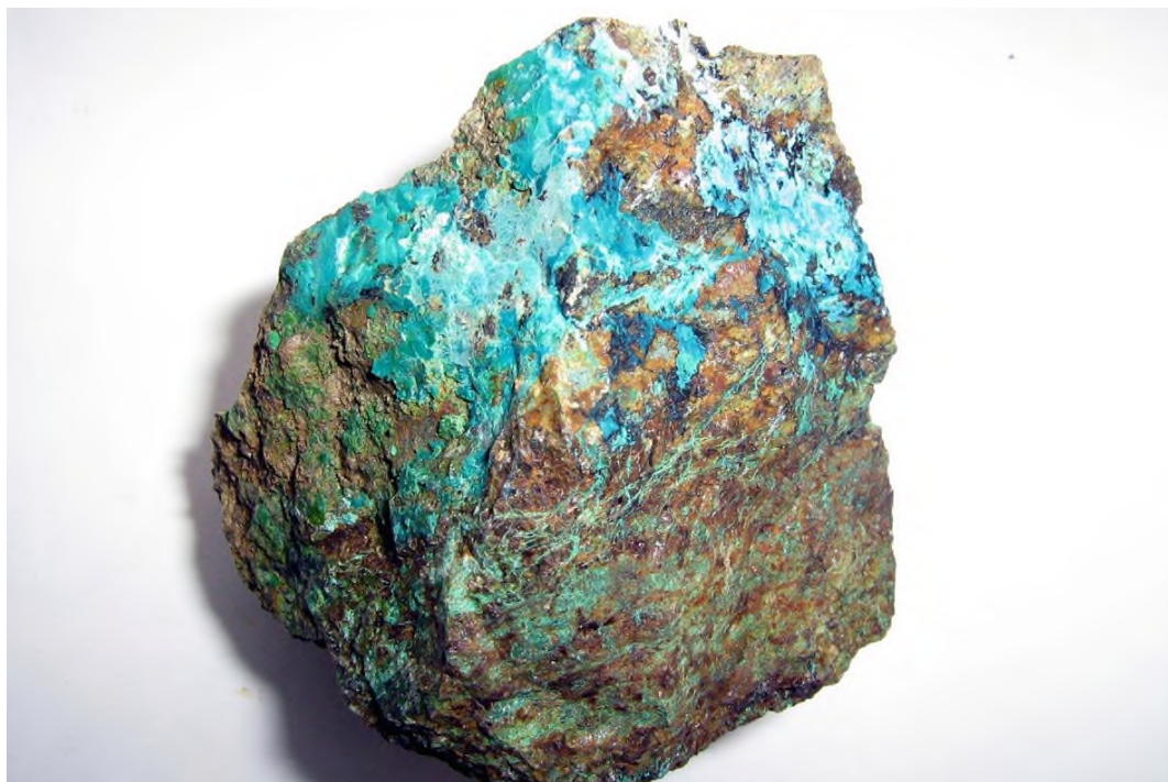
Рисунок 4.2.1 – Кристаллы, натечные массы и тонкие прожилки, выполненные хризоколлой. В тонких прожилках и в виде натечных масс на левой стороне образца – малахит [1]
