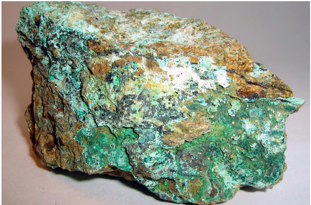
Рисунок 4.2.3 – Агрегаты малахита формируют кавернообразную пленку мощностью 1-3 мм и мелкие пятна на поверхности [1]
